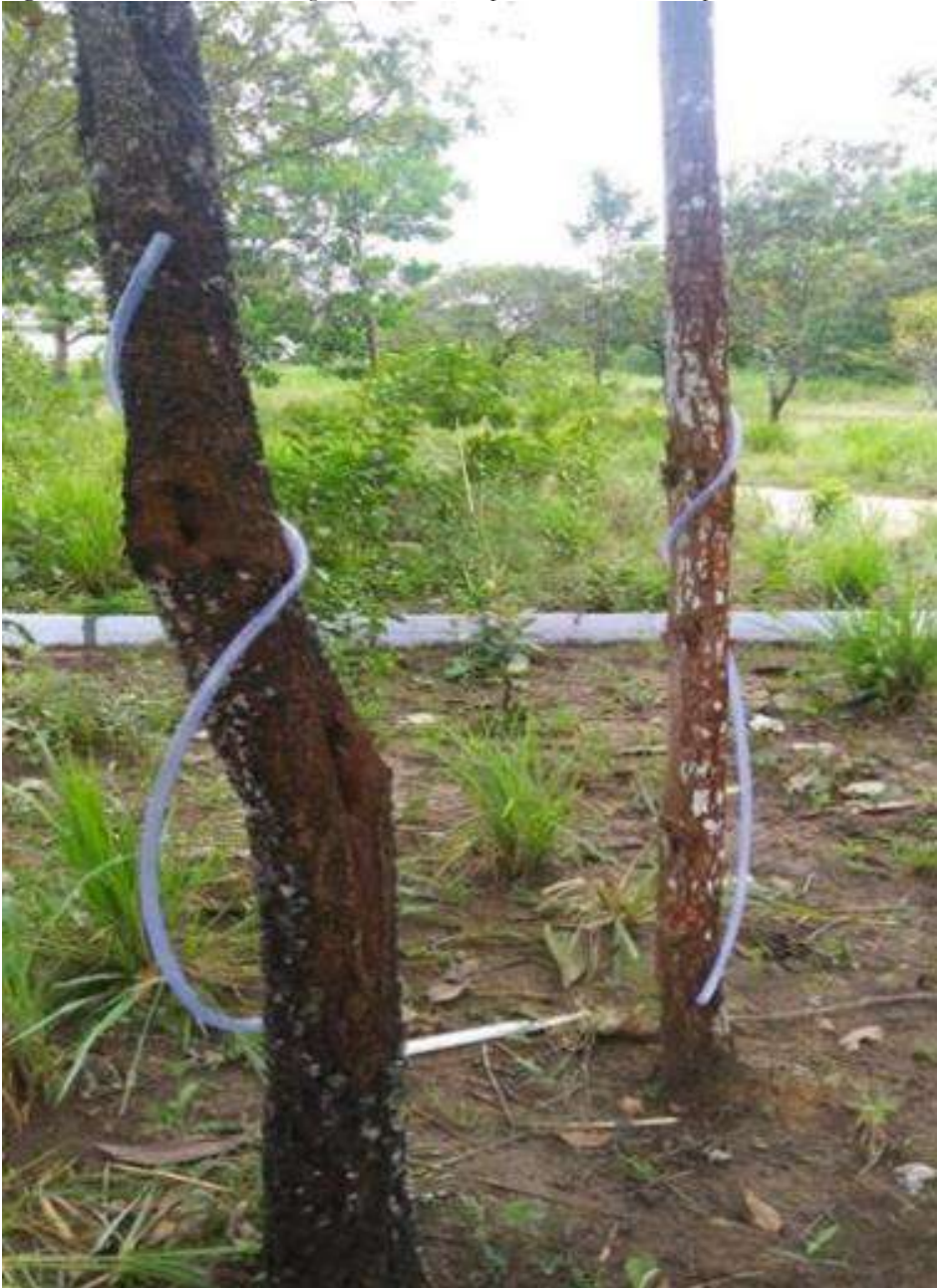
Figura 2 - Sistema de coleta de água de escoamento pelo tronco em área experimental
